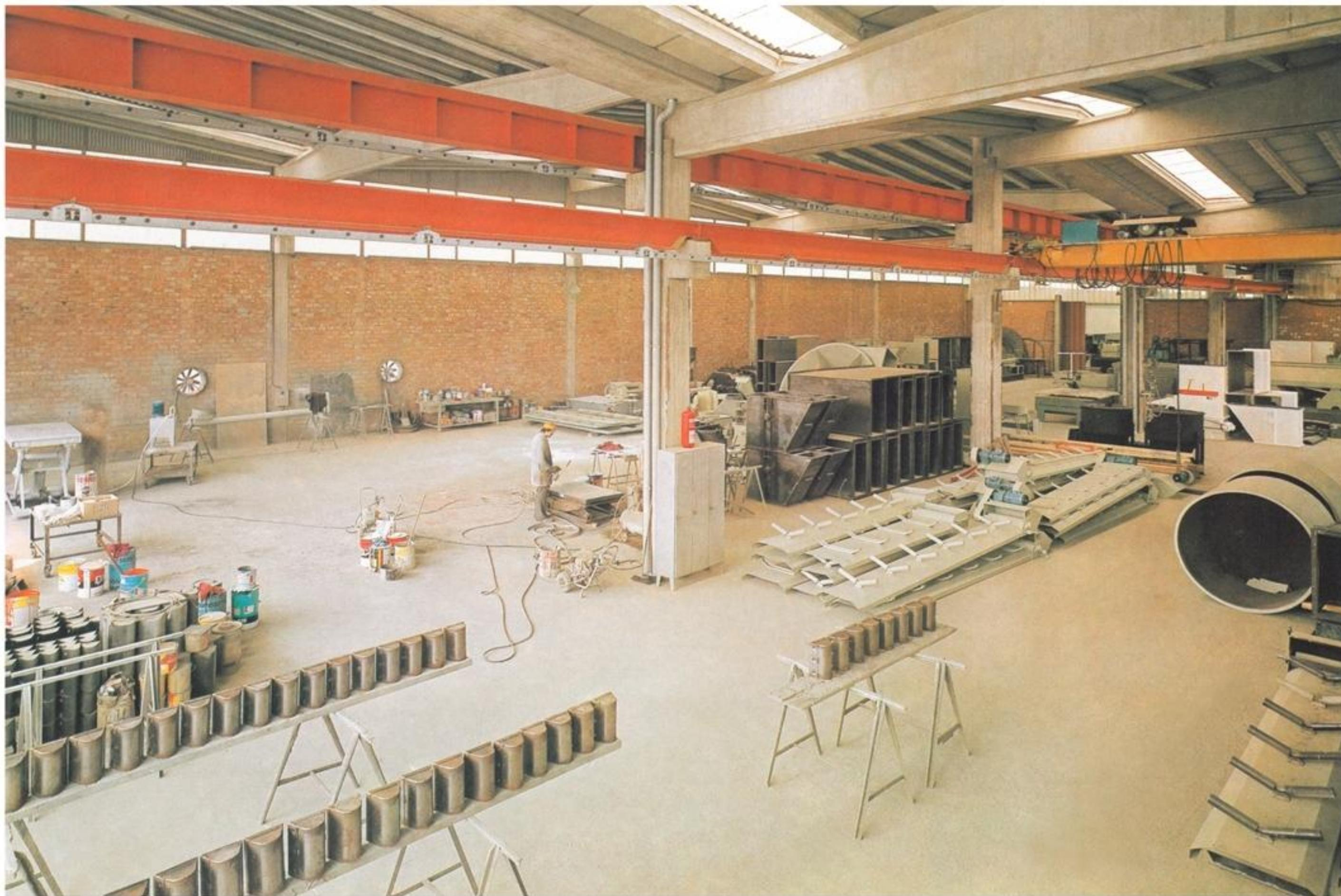
L'ampio spazio destinato a questo reparto consente l'arrivo dei materiali all'ultima fase della lavorazione e il posizionamento degli stessi, pronti per il trattamento finale di preverniciatura e smaltatura di protezione contro gli agenti corrosivi. Nel particolare una fase della verniciatura di ritocco di una piattaforma di sollevamento prima della spedizione.
