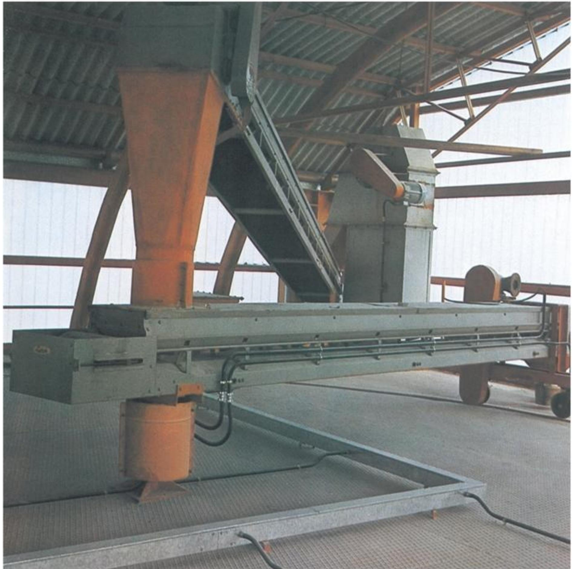
Esta instalación permite el ensilaje, la extracción, la dosificación, y el mezclado de productos en polvo de peso específico diferente y con cualquier grado de humedad. Particularmente es apta para la preparación de los compuestos para fritas y esmaltes cerámicos. Todas las secuencias son mandadas por una centralita electrónica programada y señaladas sobre un único cuadro general con sinóptico lumínoso.
