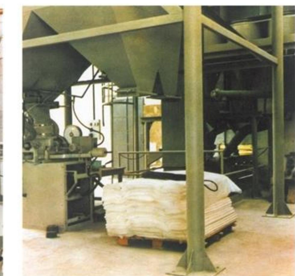
Questi impianti sono realizzati in collaborazione con lo studio tecnico Ing. Giuseppe Vandini di Modena e vengono progettati e forniti con la formula "chiavi in mano". Essi consentono la produzione di collanti in polvere per piastrelle, intonaci per interno ed esterno, malte, livellanti per pavimenti, stucchi, ecc. Gli impianti non hanno limiti di potenzialità. Occupano poco spazio e, ciò che più conta, richiedono un impiego minimo di mano d'opera (2 unità = 30 tonn/giorno).
