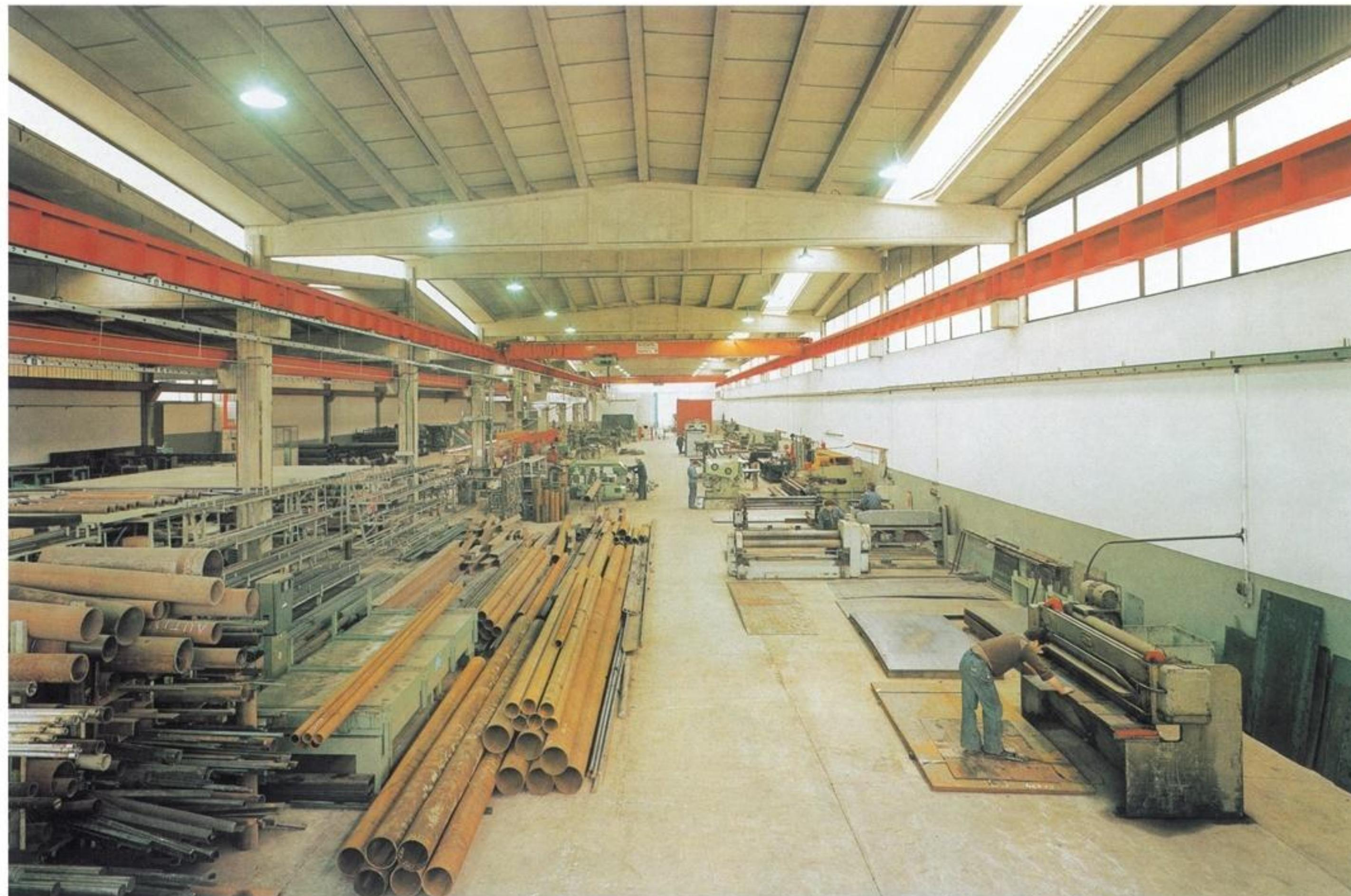
Questo reparto destinato alla lavorazione delle lamiere è sempre ben fornito di materiali di prima qualità ed è servito da macchine per i diversi trattamenti, nonchè da macchine automatiche a controllo numerico. In particolare viene lavorata la lamiera nera e la lamiera in acciaio inox. A questo reparto si affianca il magazzino dei semilavorati. Nel particolare una fase del taglio.
