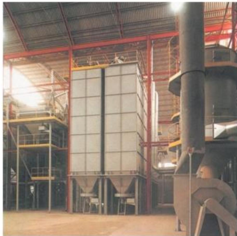
La instalación completa de molienda en seco es usada cada vez es necesario refinar terrones provenientes de una cantera de arcilla de bajo contenido de humedad. Las secciones se componen esencialmente de un desbaste preliminar de los terrones, de una sucesiva refinación mediante molinos y de una consecuente selección granulométrica del polvo. El todo es efectuado en ciclo automático controlado mediante un panel sinóptico luminoso.
